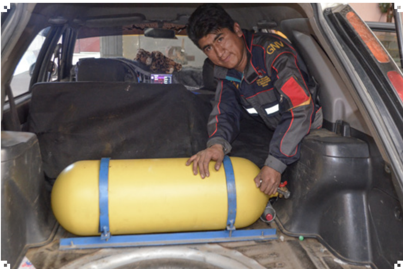
Mecánico autorizado efectúa la conversión de vehículo a Gas Natural Vehicular (GNV).
