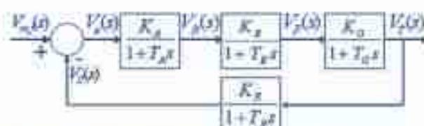
Figura 6. Diagrama de Bloques de un Sistema de Excitación
